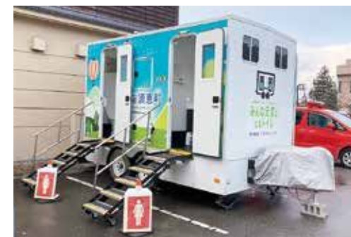
被災地で設置されたトイレトレーラー
