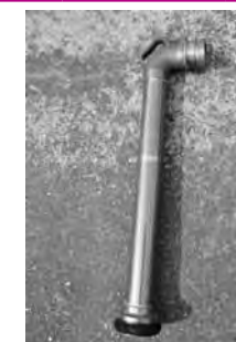
スタンドパイプ
