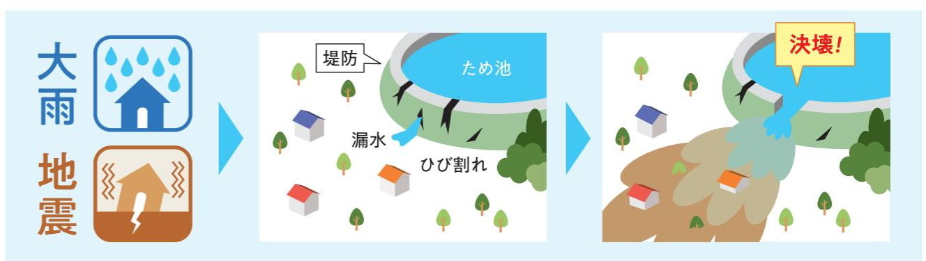
**大雨** 大雨によりため池の水位が上昇すると堤防に水が浸透して漏水が発生したり、あふれ出た水の勢いで堤防が浸食され決壊に至る恐れがあります。
