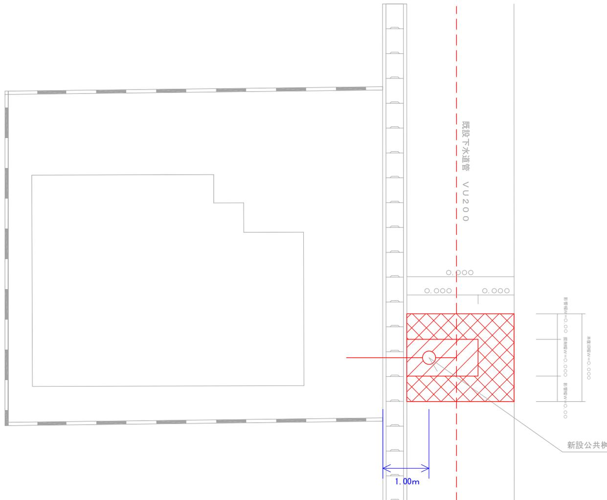
取付管の勾配は20.0%にて施工すること。また、鉄蓋が開く方向は、宅内側に開くように施工すること。
