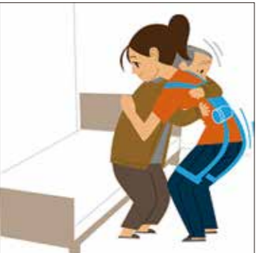
アシストスーツ (介護する人の身体負担を軽減する補助器具)
