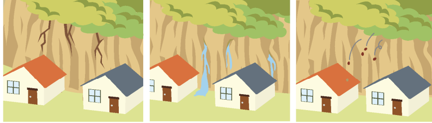
がけに割れ目が見える。 がけから水が噴出する。 がけから小石がバラバラ落ちてくる。
